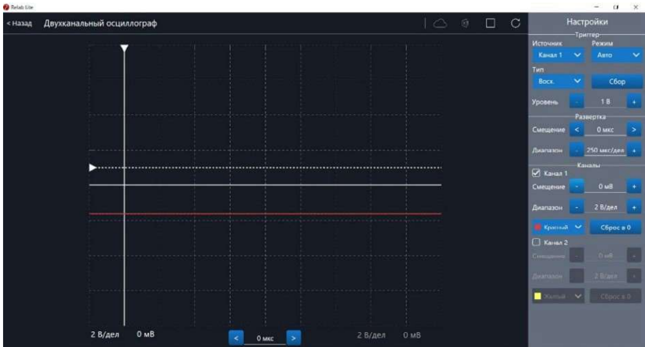
Рис. 40. Сигнал с ненулевым смещением
